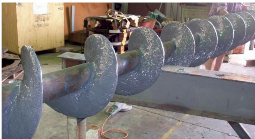
Шнек восстановлен и защищен КерамАллой СВХ
