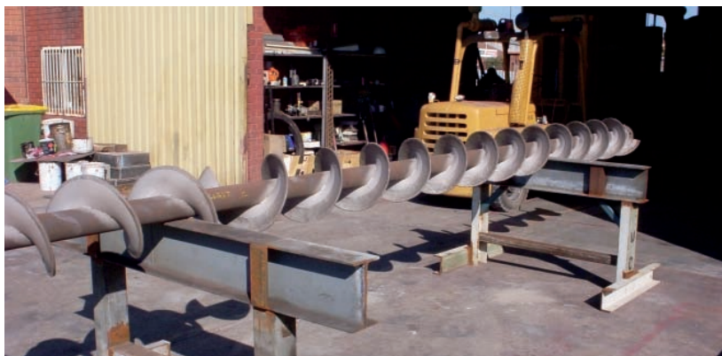
Шнек после пескоструйной обработки
